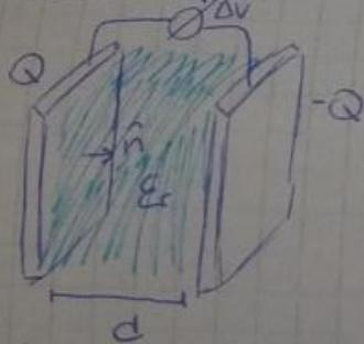
Como se puede observar que el área de las placas es mucho mayor que la distancia entre ellas ( $A \gg d$ ), si se toma el campo eléctrico en un punto interno del capacitor, lejos de los bordes, pueden considerarse estas placas infinitas y
