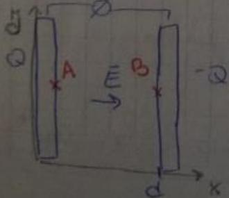
Como se trata de placas conductoras (equipotenciales), puedo calcular la diferencia de potencial desde cualquier posición de estas.
